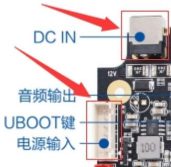
电源插座的接口定义如下，可以采用电源板供电，座子规格为 6PIN 2.54mm 间距。
